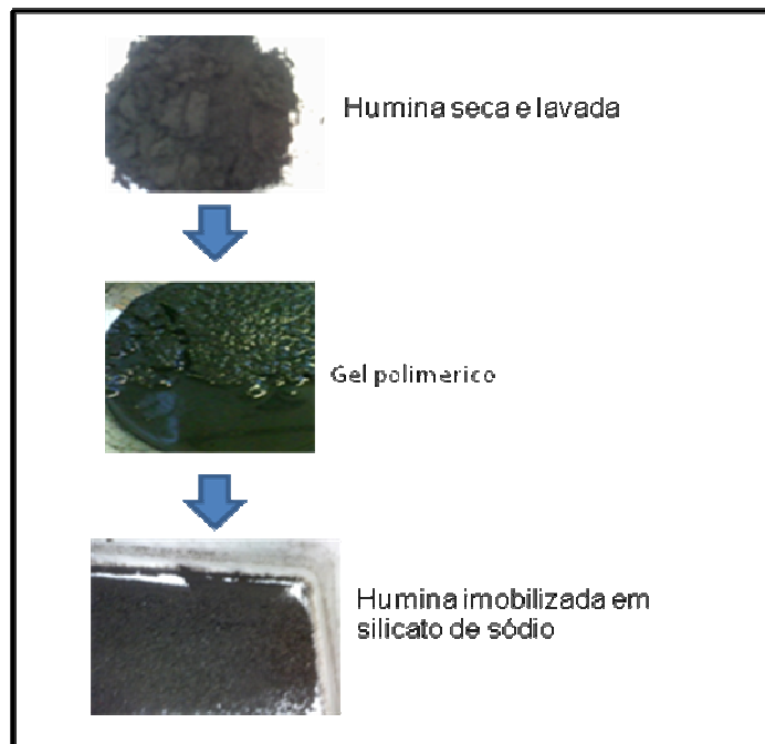
Figura 5: Imobilização de humina em silicato de sódio.
