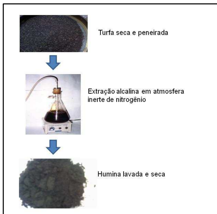
Figura 4: Extração da humina em meio alcalino.
