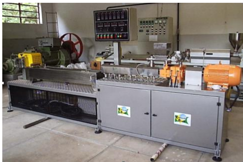
Figura 3.6 - Ilustração da extrusora de rosca dupla, Modelo DRC 22 .
