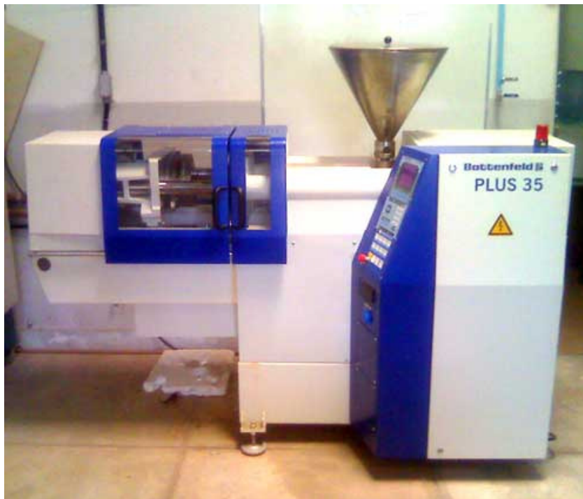
Figura 3.12 – Ilustração da injetora modelo Battenfeld Plus 35.
