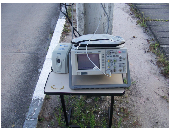
Figura 5.3. Sistema de aquisição e armazenamento posicionado em campo de teste.
