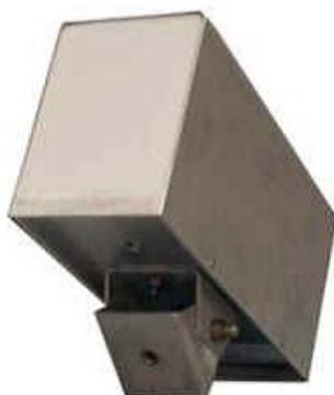
Figura 2.7. Detector de presença veicular modelo Accuwave 150LX, da empresa canadense Fortran Traffic Systems Limited. O aparelho contém um radar de microondas de onda contínua modulada em frequência, operando em 10,525 GHz (banda X). Fonte: http://www.fortrantraffic.com
