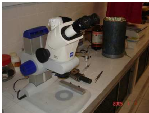
Figura 20: Microscópio utilizado na montagem da célula de pressão e ainda no alinhamento dos diamantes.
