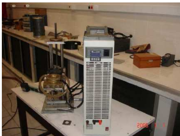
Figura 21: Forno utilizado nos experimentos de espectroscopia sob altas temperaturas.
