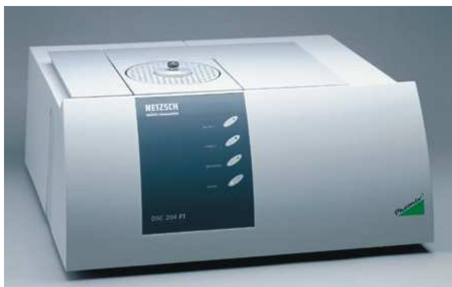
Figura 22: Equipamento DSC 204F1 da Netzsch utilizado no experimento de análise térmica.
