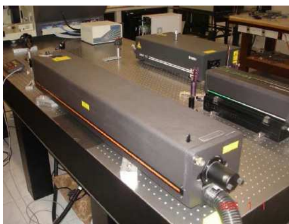
Figura 15: Laser de argônio (Ar), da marca Coherent Inc modelo Innova 70.
