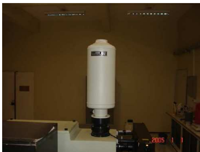
Figura 14: CCD ( Coupled Charge Device ), resfriada a nitrogênio líquido N_2 .
