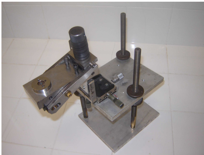
Figura 18: Célula de pressão (DAC - Diamond Anvil Cell ), utilizada nas medidas de espectroscopia Raman sob altas pressões.
