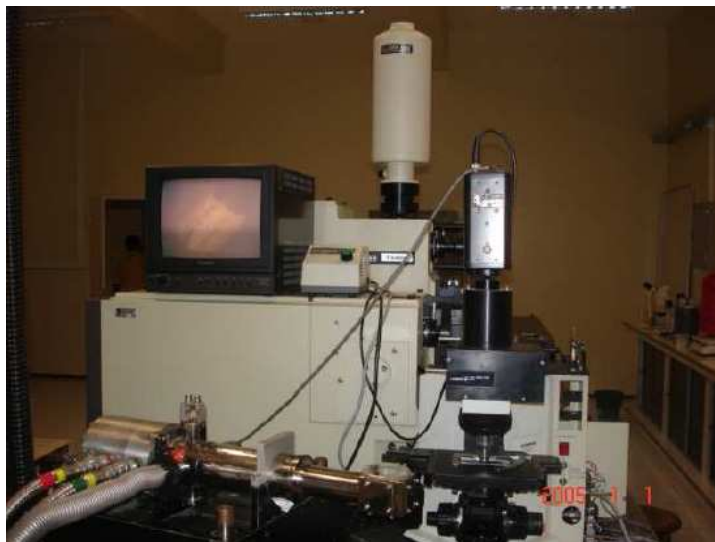
Figura 16: Microscópio Olympus BX40 e monitor acoplados a câmara de vídeo.
