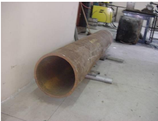
Figura 9. Tubo de aço API 5L GR B na condição como-recebida.
