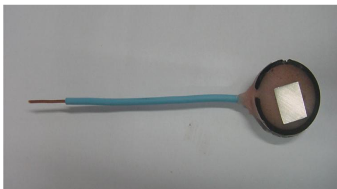
Figura 23. Amostra embutida e lixada com uma lixa nº150
