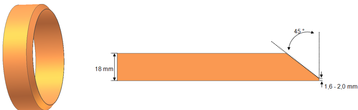
Figura 10. Esquema da geometria da junta com as dimensões em mm.
