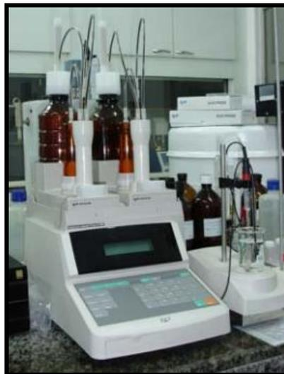
**Figura 14:** Titulador Potenciométrico Automático
