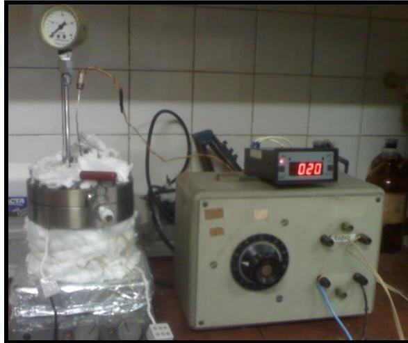
**Figura 13:** Reator semi-batelada.
