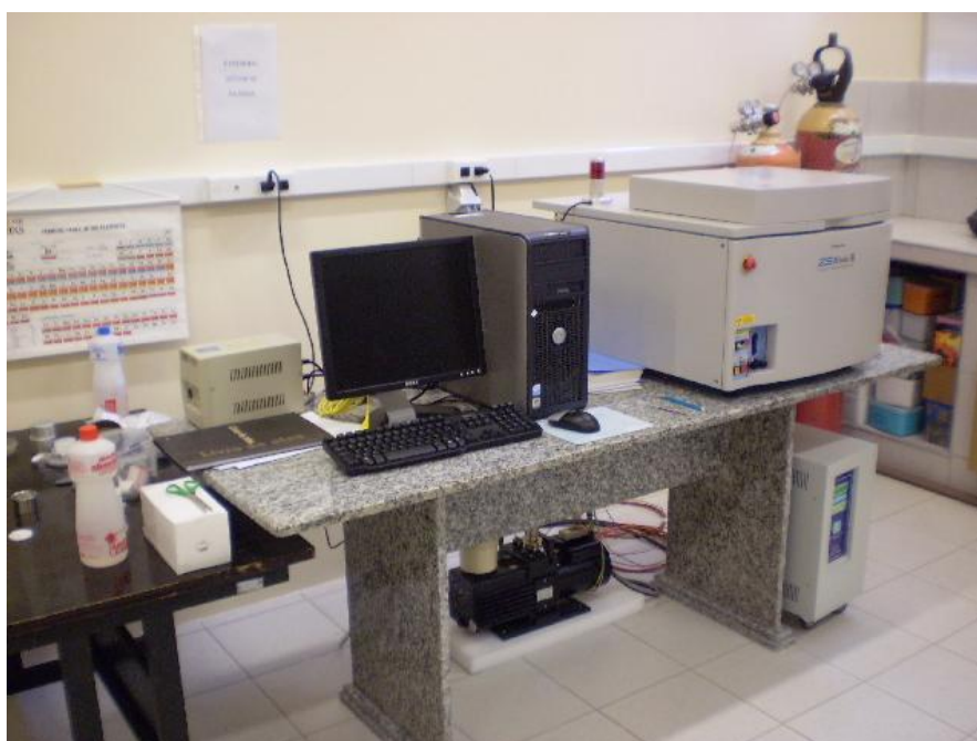
Figura 10 - Fluorescência de Raios-X/Rigaku (ZSX Mini II)
