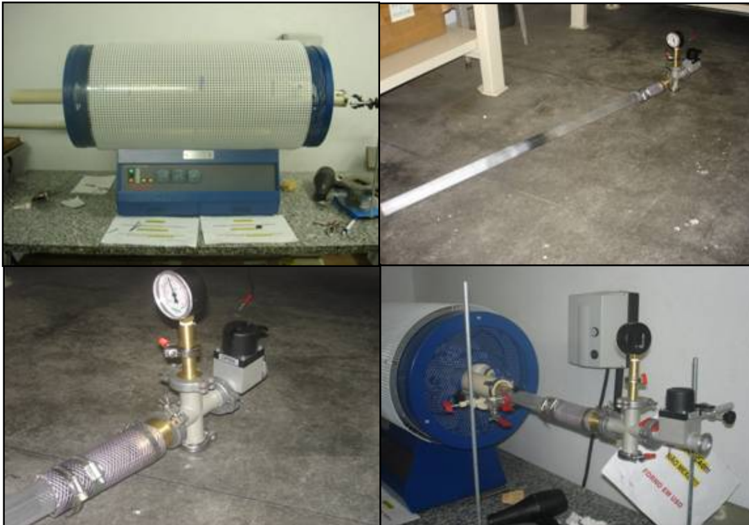
FIG. 3.14 Forno tubular, tubo de quartzo conectado a mangueira, medidor de vácuo e válvula, tubo inserido no forno
