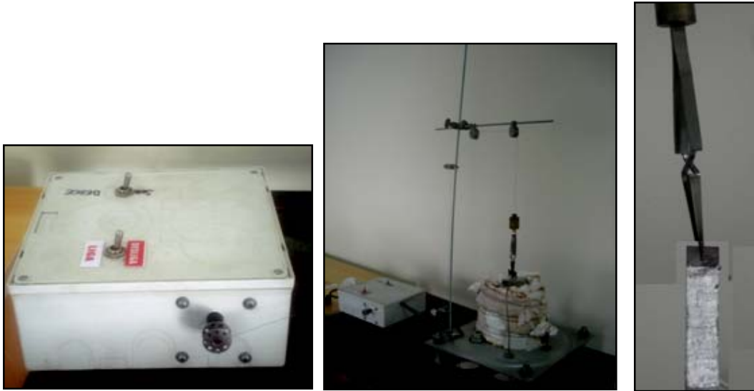
FIG. 3.10 Dispositivo de imersão para controle de velocidade
