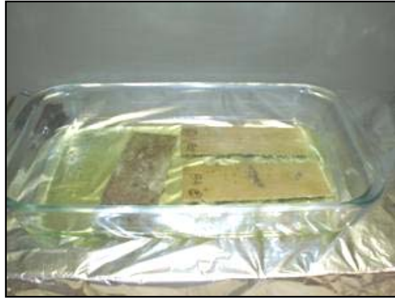
FIG. 3.20 Decapagem das chapas para teste de propriedades magnéticas
