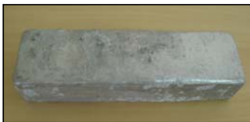
FIG. 3.15 Barra de alumino/silício gerado após solidificação
