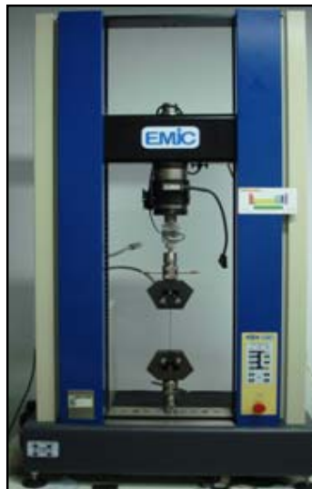
FIG. 3.29 Máquina EMIC Universal para ensaios mecânicos
