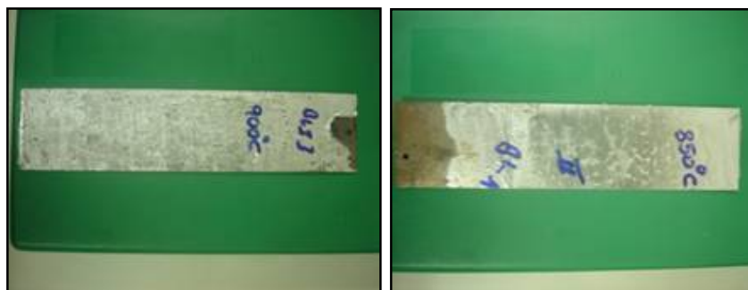
FIG. 4.1 Amostras revestidas com a liga de alumínio e silício
