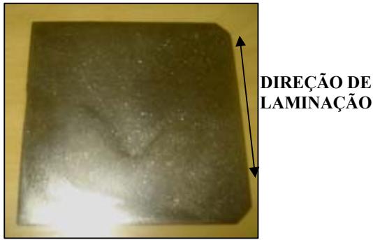
FIG. 3.19 Amostra preparada para análise de textura cristalográfica
