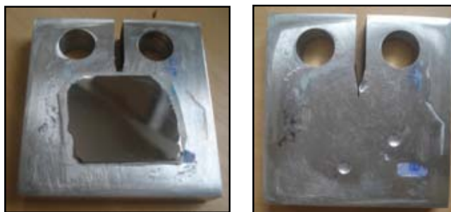
FIG. 3.18 Placa de alumínio com amostra colada (esquerda) e sem amostra colada
