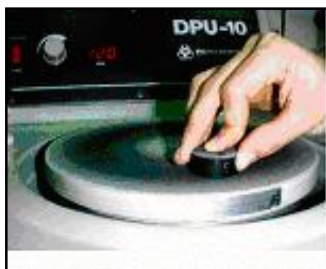
FIG. 3.17 Procedimento utilizado para lixamento e polimento em uma politriz
