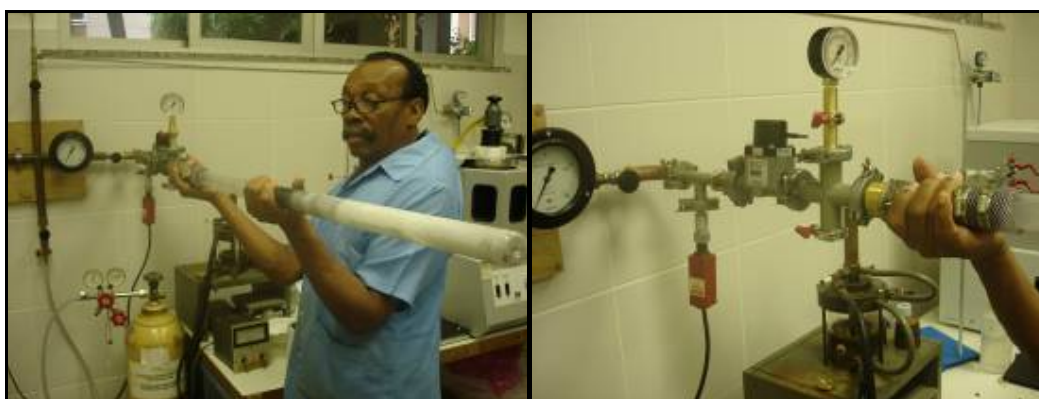
FIG. 3.13 Tubo de quartzo conectado num sistema para realização de vácuo e inserção do gás argônio
