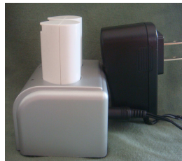
Figura 5.10 – Baterias posicionadas em suporte para serem recarregadas
