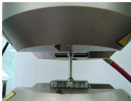
Figura 4.6 - Corpo de prova posicionado no equipamento para ensaio de tração
