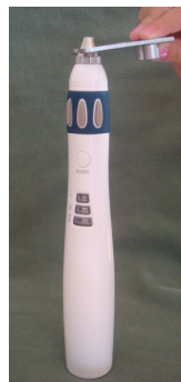
Figura 5.11 – Componente auxiliar em aço inox para remoção e troca de ponteiros
