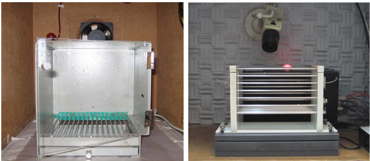
Figura 4. Fotografias das caixas experimentais utilizadas para avaliação do medo condicionado. Esquerda - Caixa de condicionamento (caixa A). Direita - Caixa de sobressalto (caixa B).
