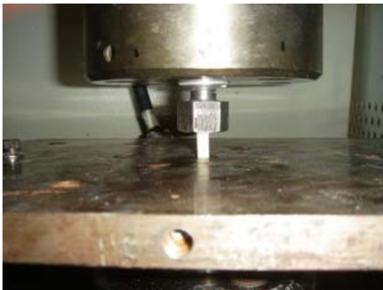
Figura 6 - Corpo de prova compacto (cp4) do osso terceiro metacarpiano posicionado para o ensaio de compressão
