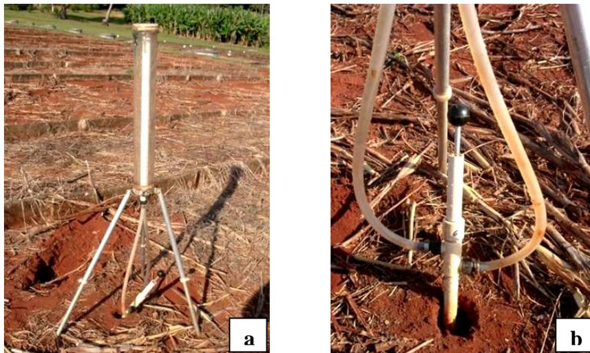
**Figura 5** - Permeômetro de carga constante modelo IAC (a); detalhe das mangueiras e da haste de ajuste da carga hidráulica (b).
