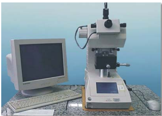
Figura 19 - Microdurômetro acoplado ao computador.
