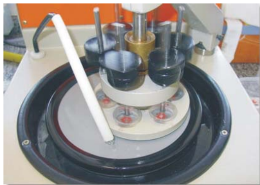
Figura 12 - Planificação e polimento dos blocos de esmalte na politriz.
