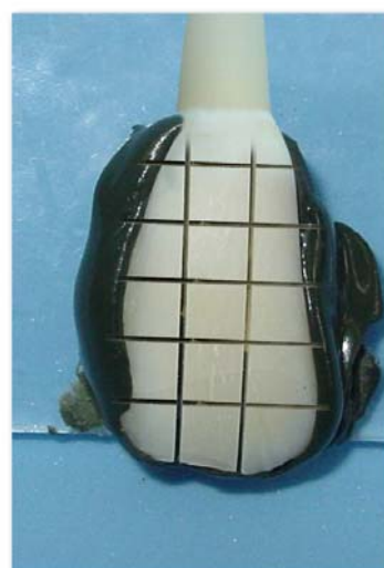
Figura 4 - Corte da face vestibular, mostrando a obtenção de blocos de dente.
