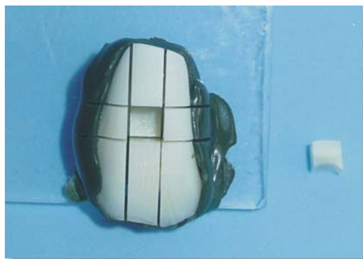
Figura 10 - Obtenção de um bloco da porção plana do dente bovino.
