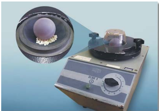
Figura 7 – Equipamento tipo gral e pistilo para obtenção do pó de esmalte.
