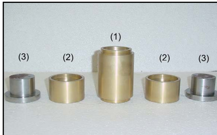
Figura 3.7 – Equipamento para moldagem dos corpos-de-prova de compressão simples: (1) cilindro principal, (2) anéis complementares e (3) êmbolos espaçadores
