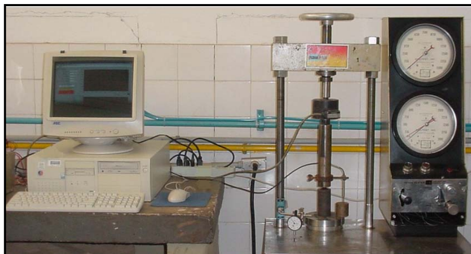
Figura 3.9 – Ruptura dos corpos-de-prova no ensaio de compressão simples
