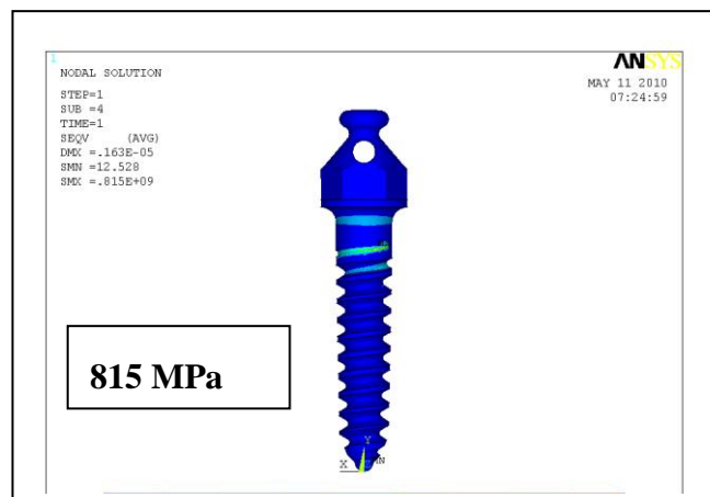
FIG. 77-Distribuição das tensões no mini-implante autorosqueante (P2), submetido à flexão e pré-tração-ângulo do filete de 65 graus
