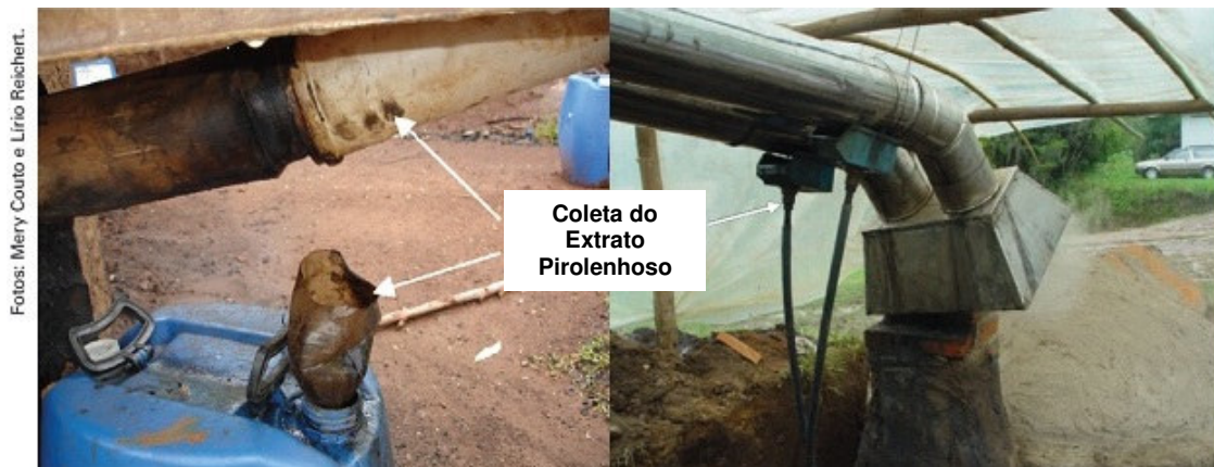
Figura 4. Detalhes da posição de uma chaminé para a produção e coleta de extrato pirolenhoso. Fonte: CAMPOS, 2007.
