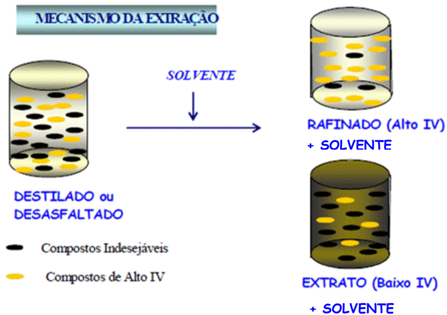
Figura 4 – Mecanismo da Extração Fonte: Nogueira (2004)
