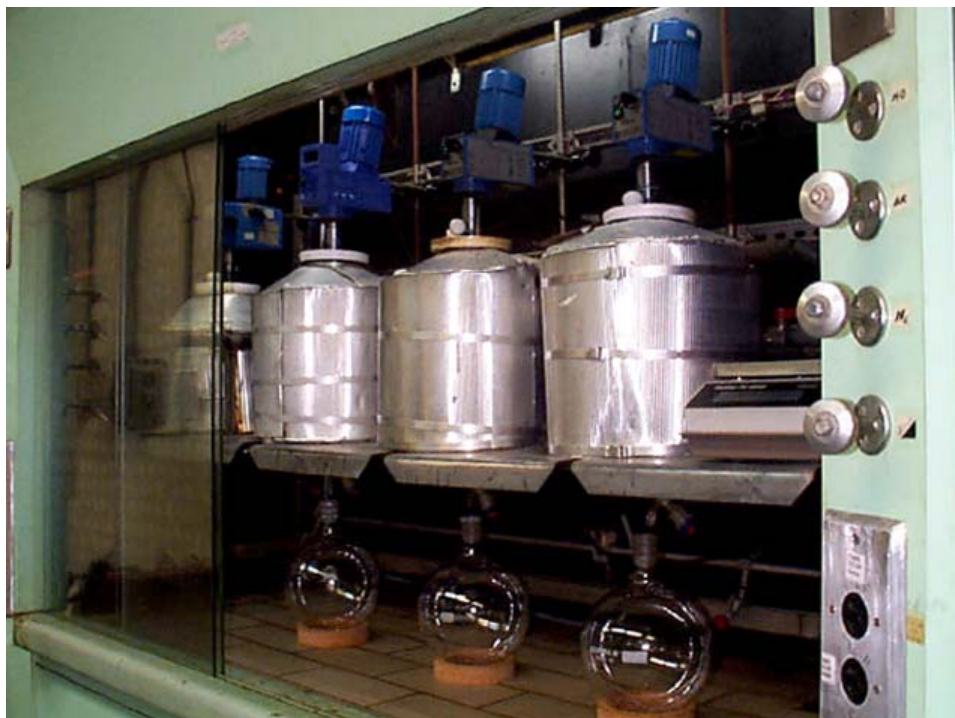
Foto 1 – Unidade de laboratório do CENPES de extração líquido-líquido Fonte : Elaborado pela autora
