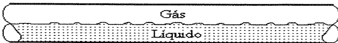
Figura 2.12- Escoamento multifásico horizontal gás-líquido do tipo estratificado ondulado.
