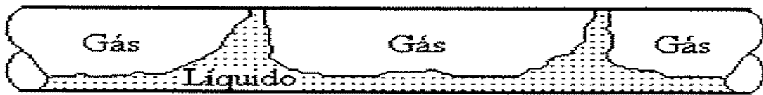
Figura 2.16- Escoamento multifásico horizontal gás-líquido do tipo anular ondulado.
