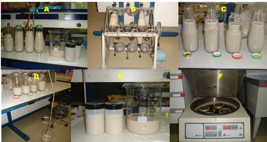
**Figura 9:** (a) Preparo das suspensões; (b) Agitação; (c) Decantação; (d) Sifonação; (e) Amostras para centrifugação; (f) Centrifugação. [Fonte: cedida pelo prof. Dr. Paulo Sérgio Calefi].
