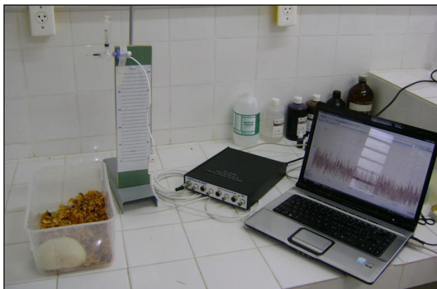
Figura 13: Aparato utilizado para as medidas de PA e FC em ratos.
