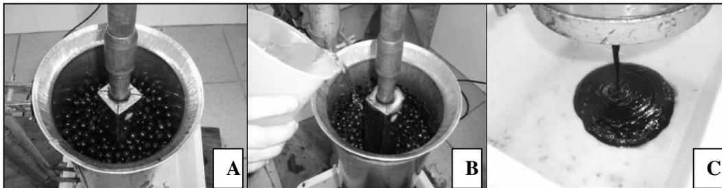
**Figura 4** Processamento de jussara (*Euterpe edulis*) em despulpadeira vertical; frutos dentro do cilindro de aço inoxidável (A); adição de água durante o despulpamento (B); saída do açaí por orifício no fundo da despulpadeira (C).
