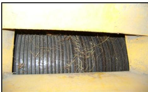
**Figura 21.** Lâminas do desfibrador usado para desaglomerar as fibras de bananeira (Elaboração própria)
