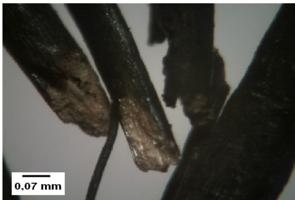
Figura 15. Fibra de coco modificada com presença de PANi somente na superfície da fibra
