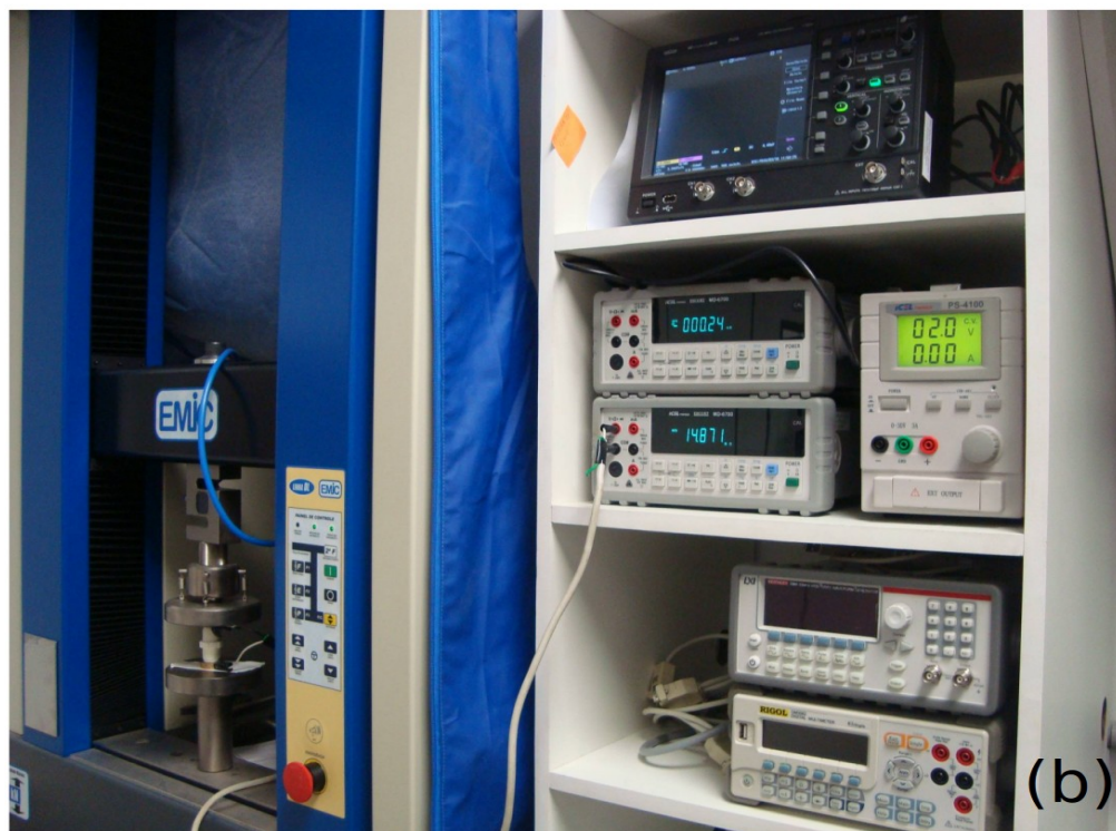
Figura 12. Esquema (a) e foto (b) do sistema usado para medidas de sensibilidade à compressão
