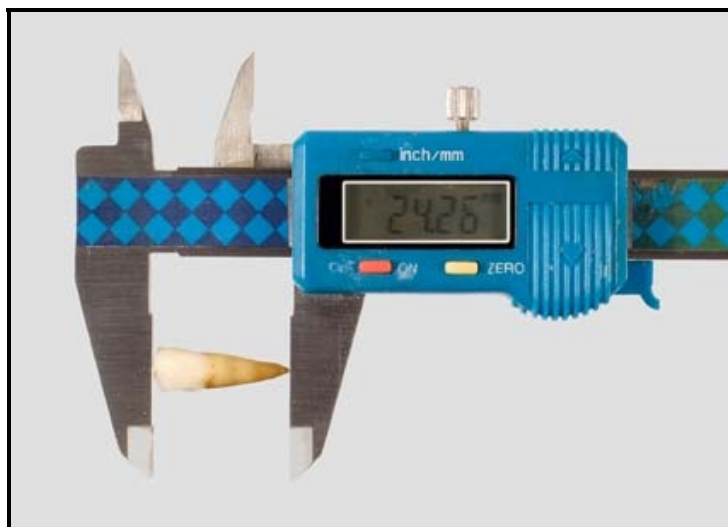
Figura 01 – Aferição do dente na seleção da amostra utilizando Paquímetro eletrônico digital Digimes®.
