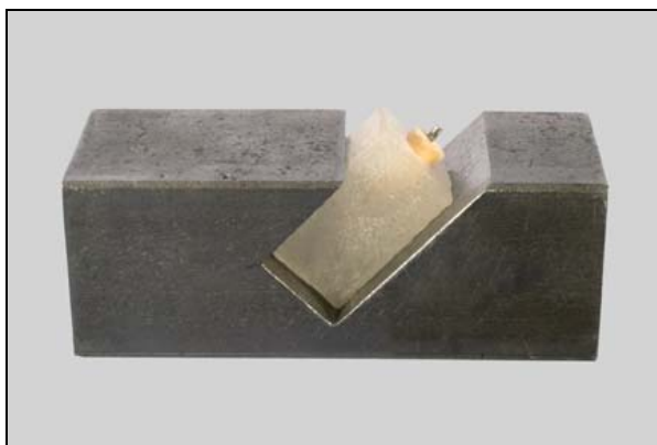
Figura 06 – Corpo-de-prova posicionado na base de metal com angulação de 45° em relação ao plano horizontal.
