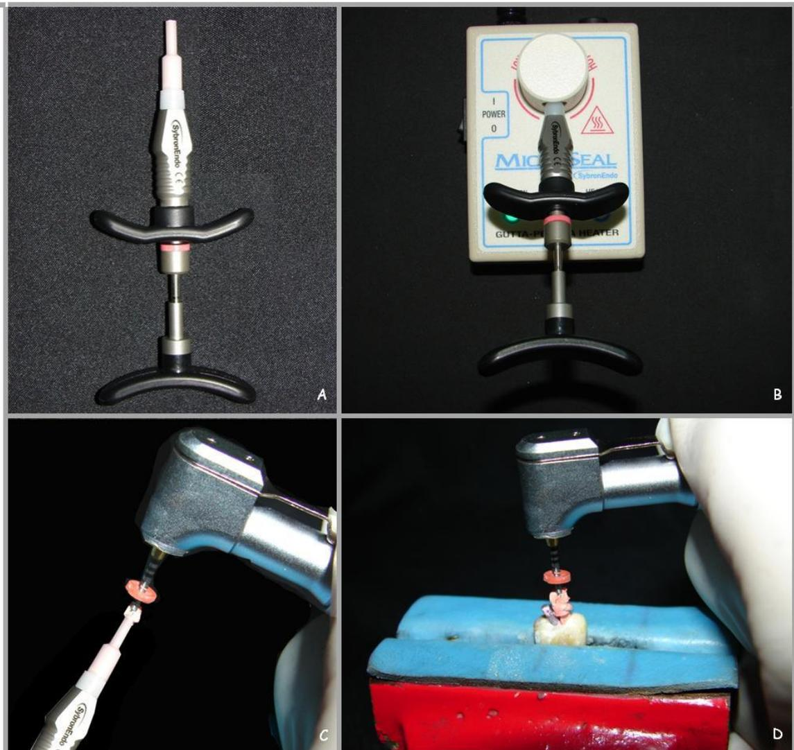
**Figura 5.** A) Seringa de metal com cartucho de gutta-percha do sistema em posição; B) Conjunto seringa-gutta-percha colocado no termoplastificador; C) Termocompactor inserido no cartucho para retirada da gutta-percha termoplastificada; D) Termocompactor no interior do canal com a gutta-percha.
