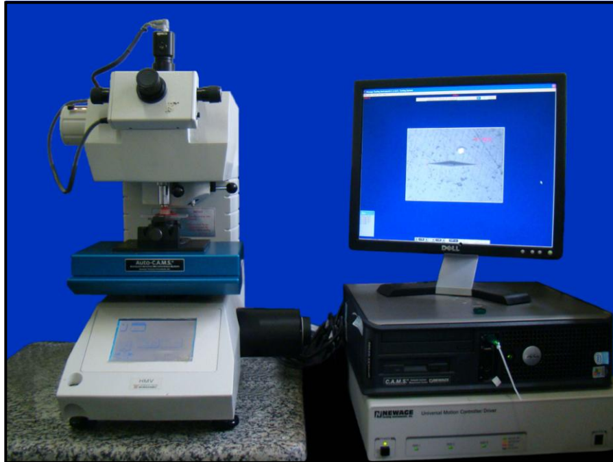
Figura 10: Microdurômetro Shimadzu HMV2 acoplado ao computador, que mostra em seu monitor a marcação de microdureza a ser aferida.
