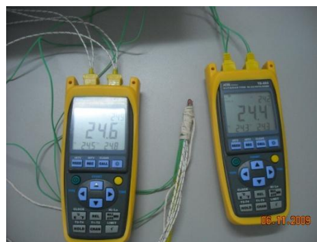
Figura 3.18. Termômetro tipo datalogger .
