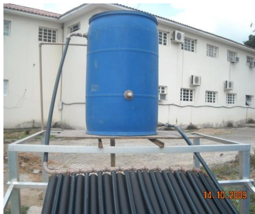
Figura 3.9. Detalhes das conexões na parte superior do coletor.
