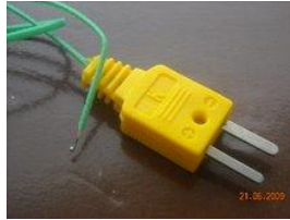
Figura 3.15. Termopar tipo K(cromel-alumel)
