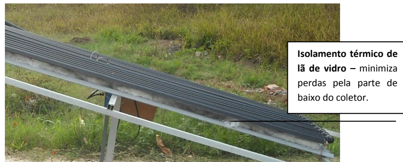
Fig. 3.5. Detalhes do isolamento térmico do coletor.
