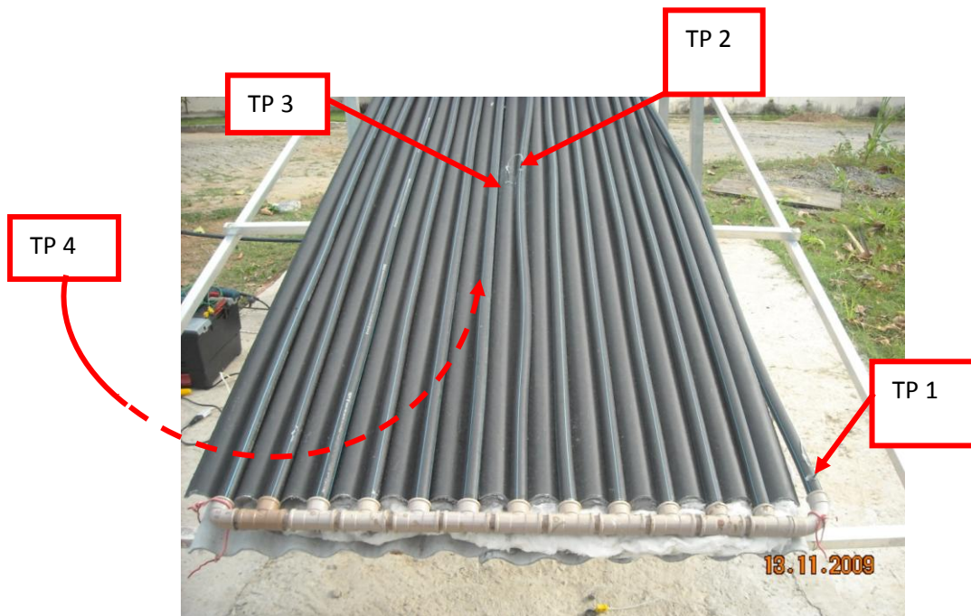
Figura 3.16. Detalhes da instalação dos termopares
