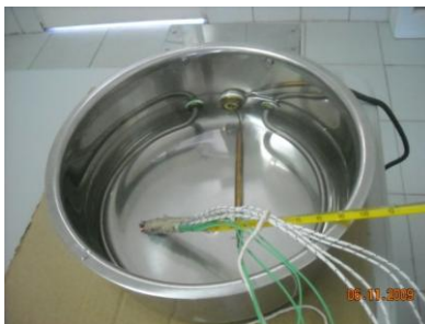
Figura 3.23. Ebulidor utilizado para aquecer a água.
