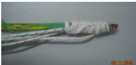
Figura 3.22. Termopares fixados ao termômetro de mercúrio.
