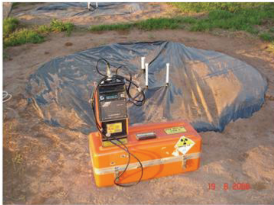
Figura 7 – Sonda de nêutrons na posição de leitura padrão (A) e no tubo de acesso (B), no qual se realizou as leituras nas profundidades de 0,2; 0,4; 0,6 e 0,8 m
