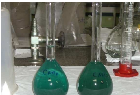
Figura 1B- Exemplo de procedimento em laboratórios para extração em ácido cítrico e CNA para os materiais A (1,2 e 3) e B (4, 5 e 6)
