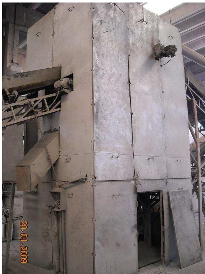
Figura 6A – Moinho de martelos para redução do tamanho da escória britada
