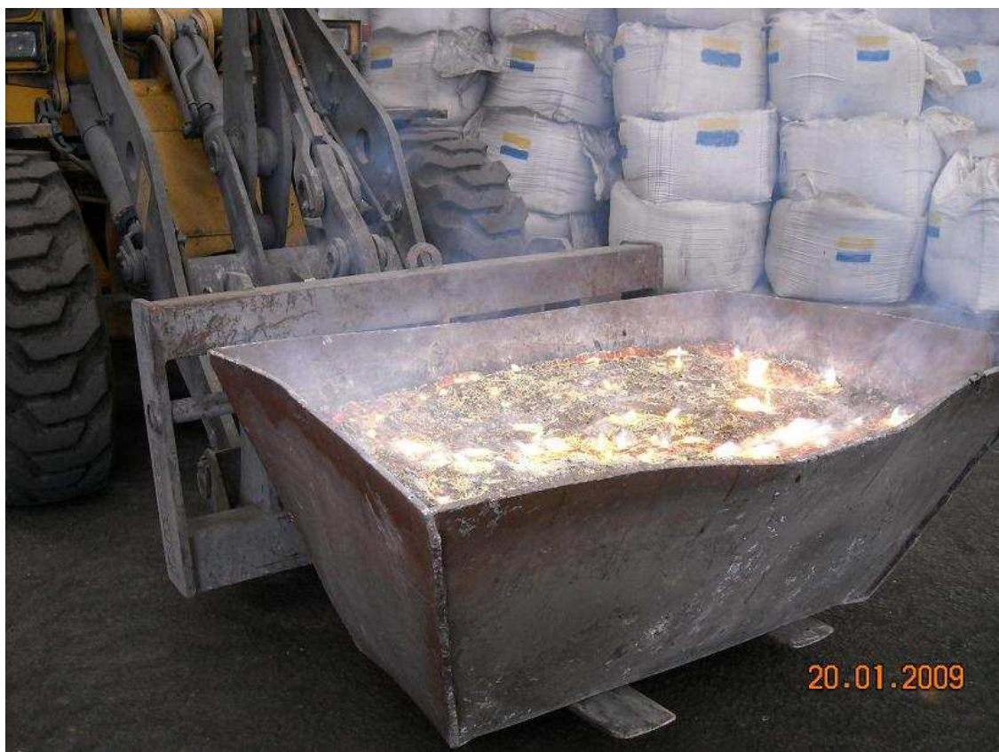
Figura 3A – Retirada do sobrenadante da fusão, composto de oxissilicatos dos metais fundidos e que após resfriamento forma a escória deste processo
