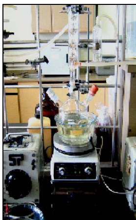
Figura 45 - Sistema empregado na síntese da 2-fenil-2-oxazolina pelo método convencional
