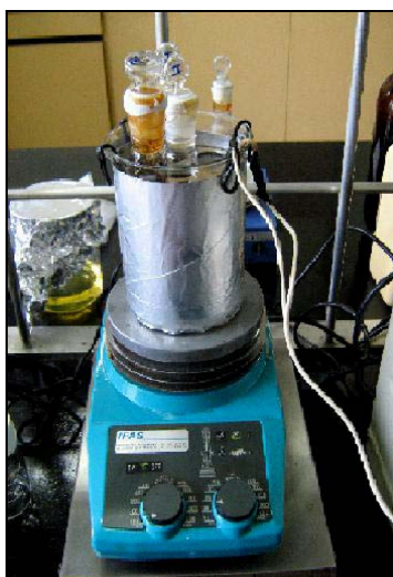
Figura 46 - Sistema para a polimerização em massa da 2-fenil-2-oxazolina pelo aquecimento convencional
