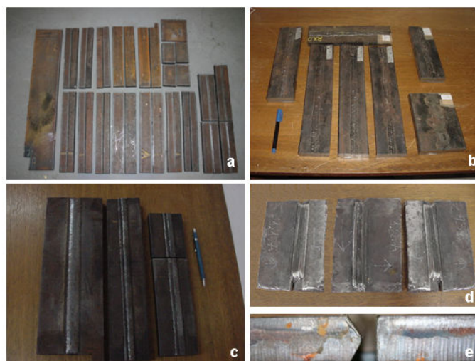
Figura 4.2 –Corte e soldagem do aço API 5L X80 para todos os processos, a) corte da chapa, b) soldagem M1 e M2, c) Soldagem R1, d) soldagem R2, e) Forma do chanfro.
