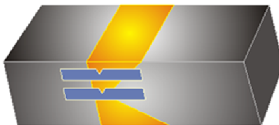
Figura 4.15 – Representação do local de retirada dos corpos de prova, com entalhe no passe de enchimento e no passe de raiz.
