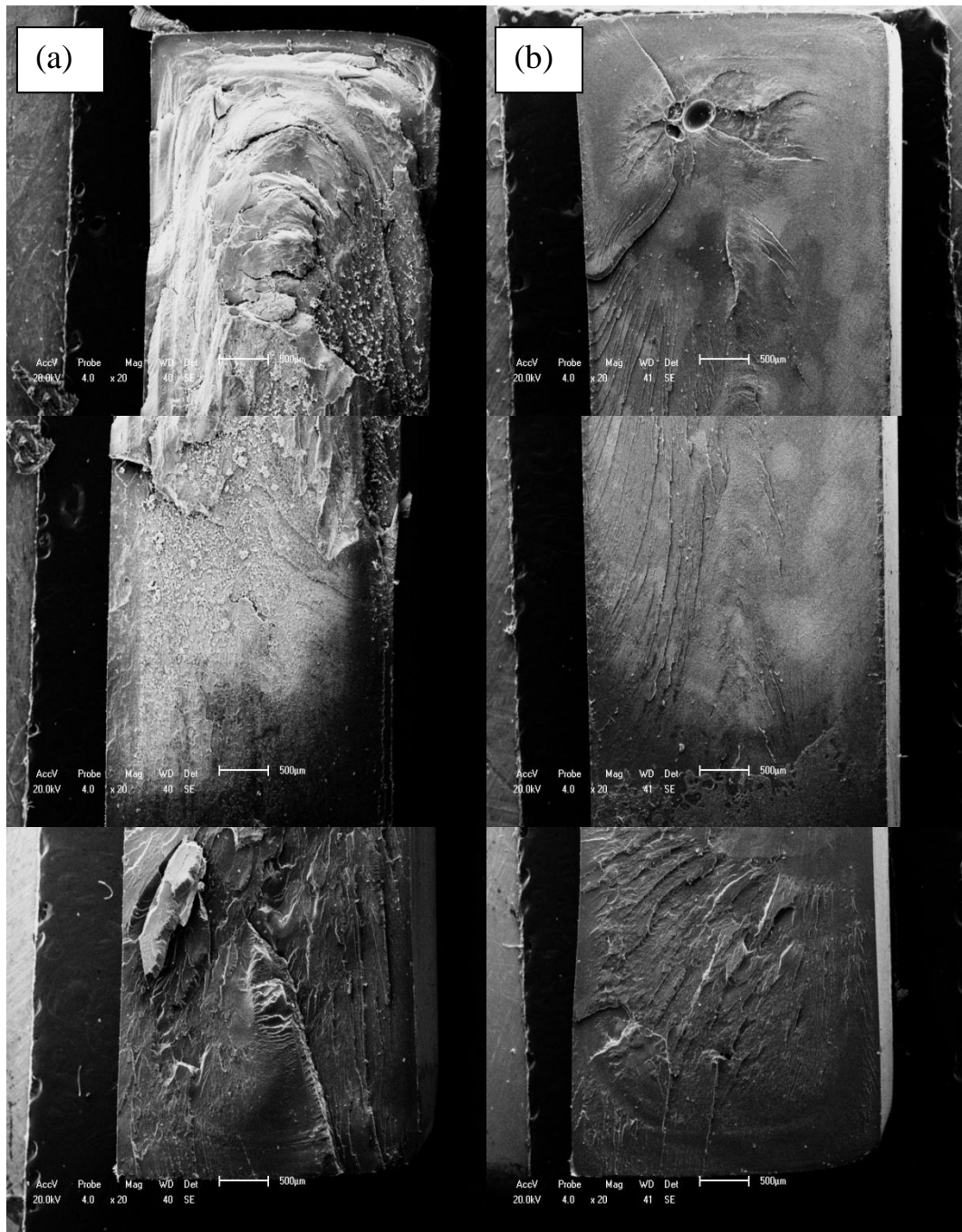
Figura 4.27 – Micrografia da superfície de fratura do PHB, ensaiado por fadiga na carga de 549 N. (a) Na ausência do Fluido e (b) Na presença do Fluido NaOH (3M).
