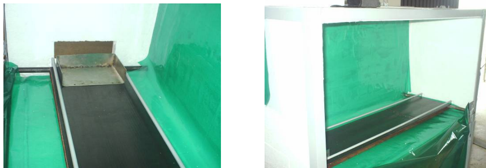
FIGURA 7. Imagens internas da estrutura confeccionada para realização do ensaio utilizado para resfriamento do ambiente próximo ao bico de pulverização.
