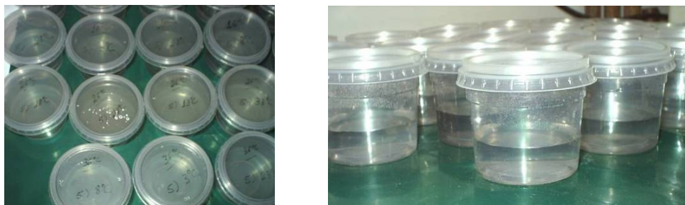
FIGURA 13. Amostras coletadas para análise de deposição (condutividade elétrica - \mu\text{S cm}^{-1} ) já com a dosagem de 50 mL de água destilada e deionizada.
