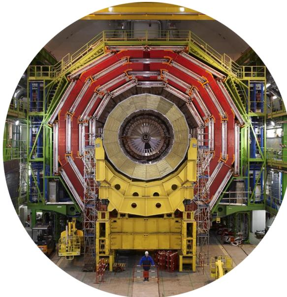
Figura 3.17: Um dos discos que formam o **CMS** na caverna, onde pode-se observar a instalação das câmaras de múons, encrustadas nas regiões de retorno de fluxo do campo magnético.
