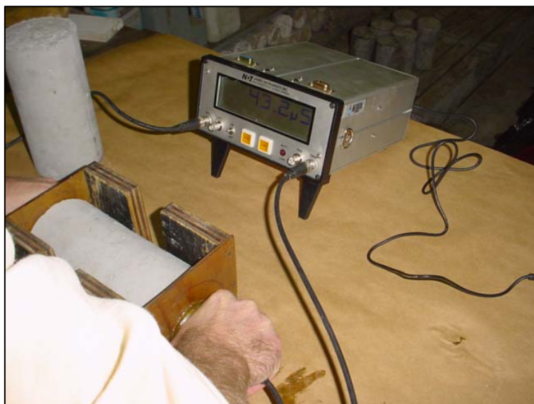
Figura 5.4: aspecto da realização de um ensaio para determinação da VPU.
