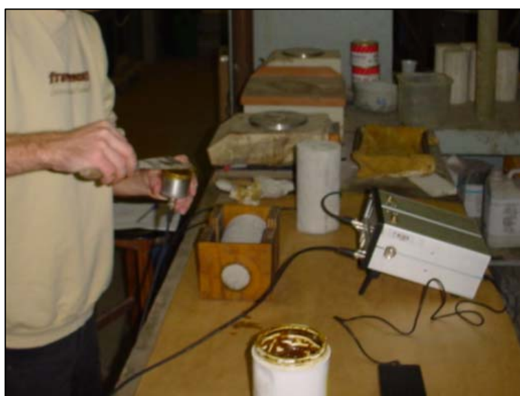
Figura 5.5: aplicação de acoplante sobre os transdutores.
