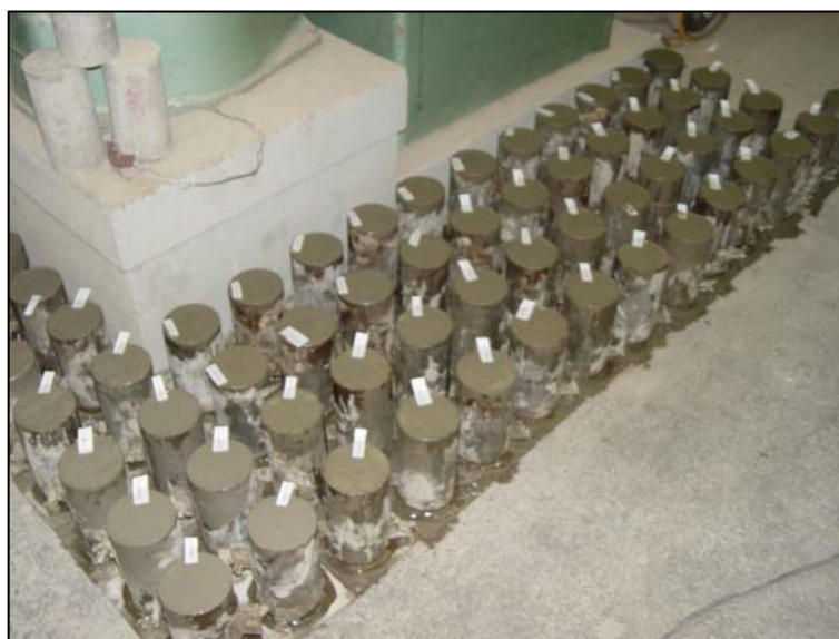
Figura 5.1: corpos-de-prova moldados após a concretagem
