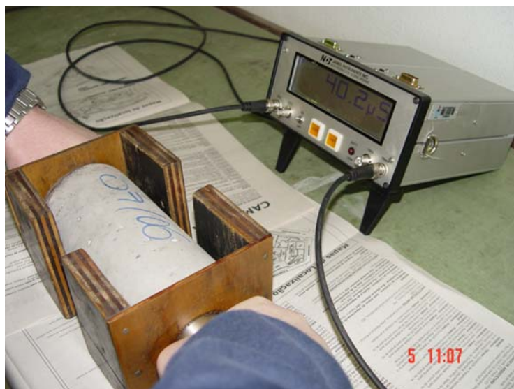
Figura 2.3: aspecto de execução do Ensaio de VPU.
