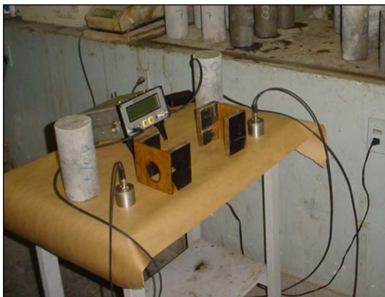
Figura 5.3: vista do equipamento e do gabarito para posicionamento dos transdutores.
