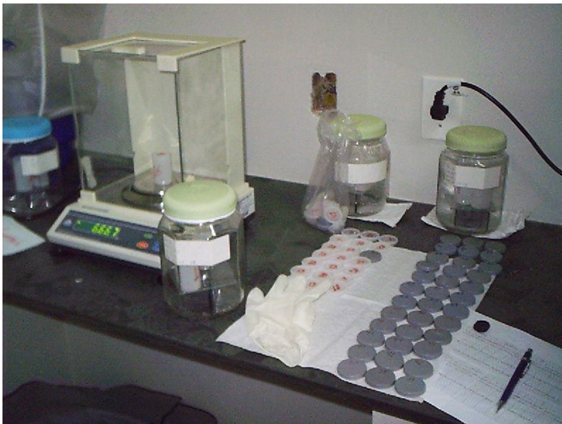
FIGURA 1A – Pesagem diária dos recipientes de sorção com amostras de arroz-vermelho variedades PB01 e PB05 para os experimentos de adsorção e dessorção.
