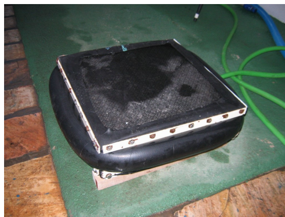
Fig. 9: Plataforma de Força construída por Roesler (1997) Laboratório de Biomecânica Aquática - UDESC
