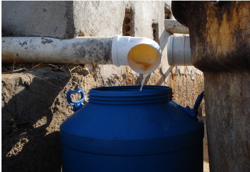
FIGURA 8 – Coleta do efluente para determinação do volume.
