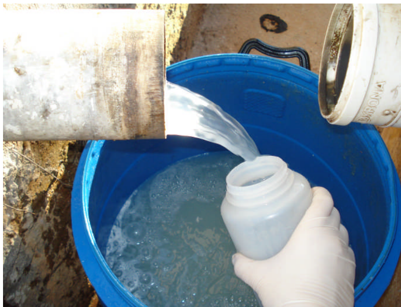
FIGURA 9 - Coleta do efluente bruto e recipiente utilizado.
