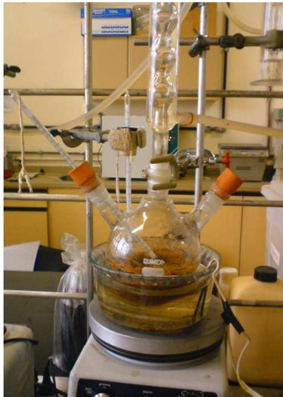
Figura 13 – Esquema para acetilação das fibras
