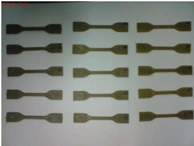
Figura 16 – Corpos de prova para os ensaios mecânicos
