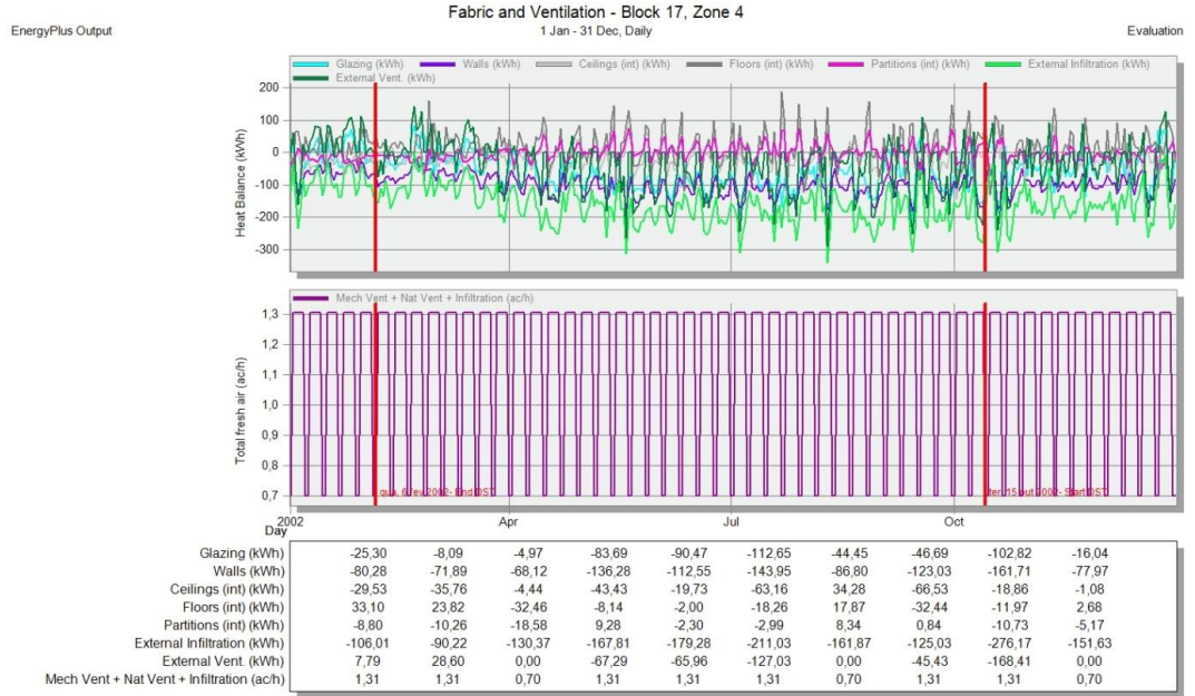
Gráfico 97: Gráfico comparativo dos dados de ventilação (períodos diários) para Edifício Eldorado Tower, São Paulo SP; Extraído da simulação no “Design Builder”.
