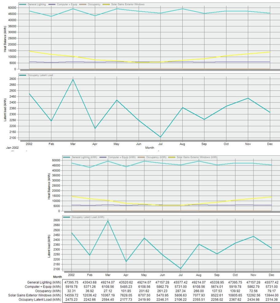
Gráfico 49: Gráfico comparativo dos dados de ganhos internos (períodos mensais) do Edifício Gustavo Capanema no Rio de Janeiro, RJ; Extraído da simulação no "Design Builder"
