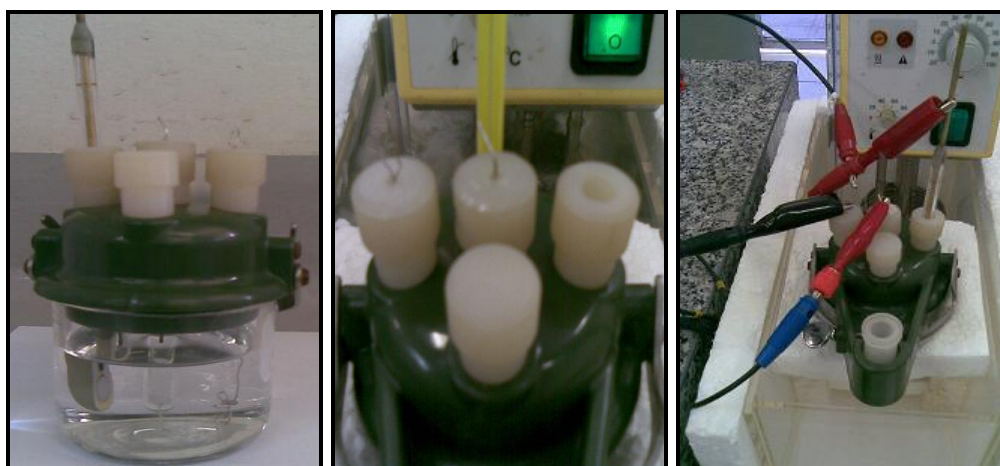
Figura 15 – Da esquerda para a direita: cela eletroquímica, tampa da cela com os três eletrodos e um termômetro, e o banho termostático com os eletrodos e as garras.
