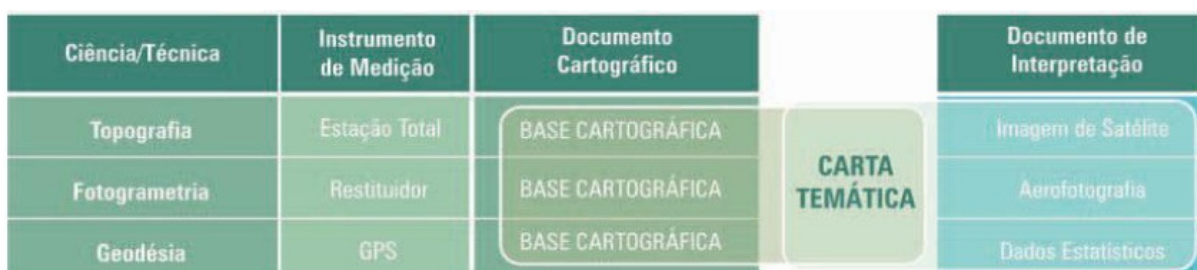
Figura. 5 - Estrutura do processo de elaboração de mapas temáticos Fonte: ERBA e LOCH, 2007.
