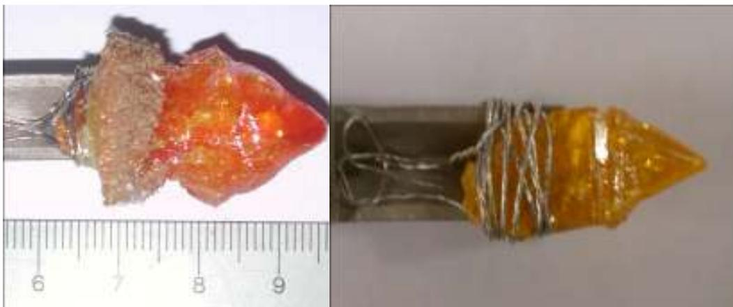
**Figura 4.8** - Cristais crescidos a partir da composição  $1\text{Bi}_2\text{O}_3 : 1,03 \text{TeO}_2$ , com velocidade de puxamento de  $0,5 \text{ mm/h}$  e rotação de  $10 \text{ rpm}$  ( $\text{Bi}_2\text{TeO}_5$ -004, à direita) e  $15 \text{ rpm}$  ( $\text{Bi}_2\text{TeO}_5$ -005, à esquerda).
