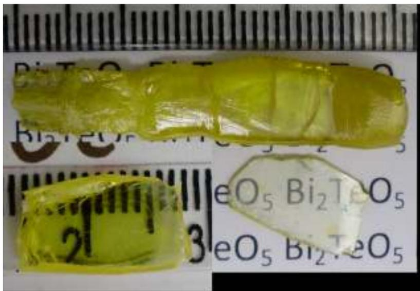
**Figura 4.11** - Acima, cristal  $\text{Bi}_2\text{TeO}_5$ -026 e abaixo, amostras cristalinas obtidas por clivagem e usadas nas medidas ópticas preliminares.
