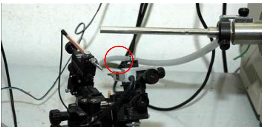
**Figura 18:** Detector Eletroentenográfico (IOCHB) com ênfase para os eletrodos onde está inserida a antena do macho de *D. flavipennella*.
