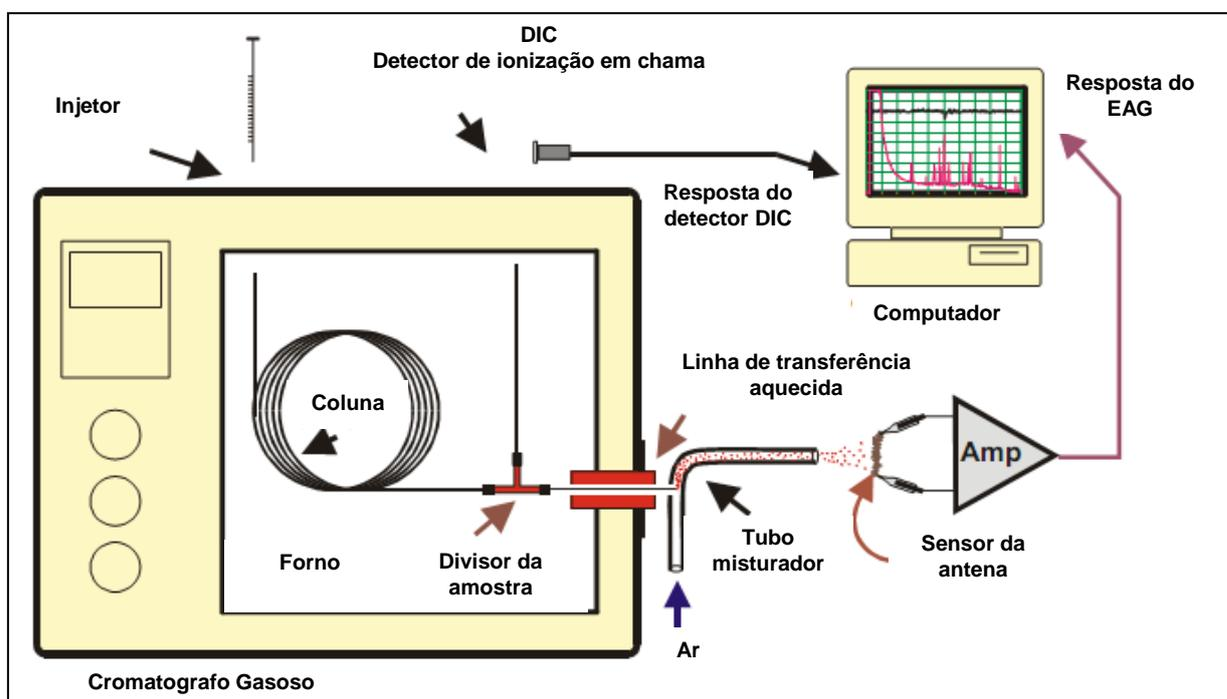
**Figura 6A:** Esquema de um CG-EAG (Adaptado de Syntech, 2004)
