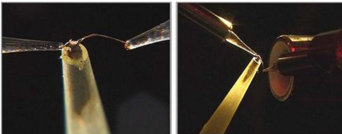
**Figura 7:** Preparação da antena para EAG.
