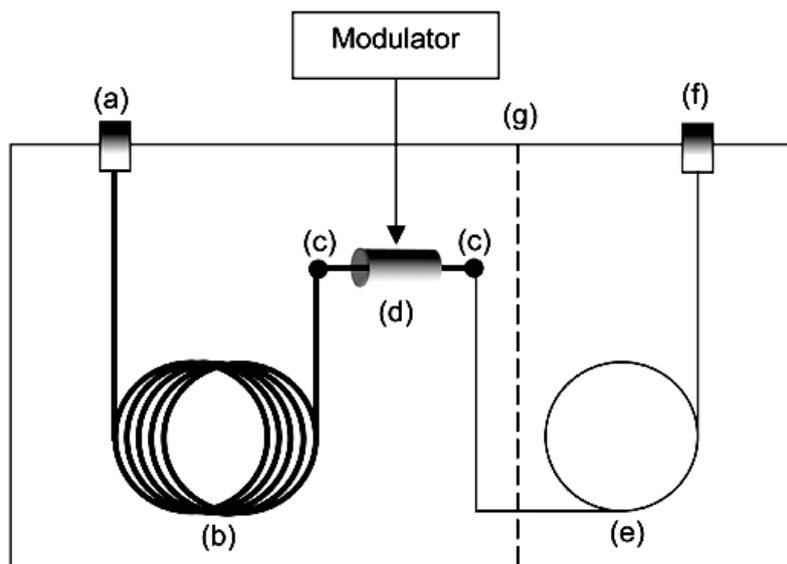
**Figura 9:** Diagrama básico de um sistema CG x CG onde: (a) injetor, (b) coluna primária, (c) conectores de coluna, d) interface CGxCG, (e) coluna secundária, (f) detector e (g) divisão opcional para um forno secundário (extraído de Dmandja, 2004).
