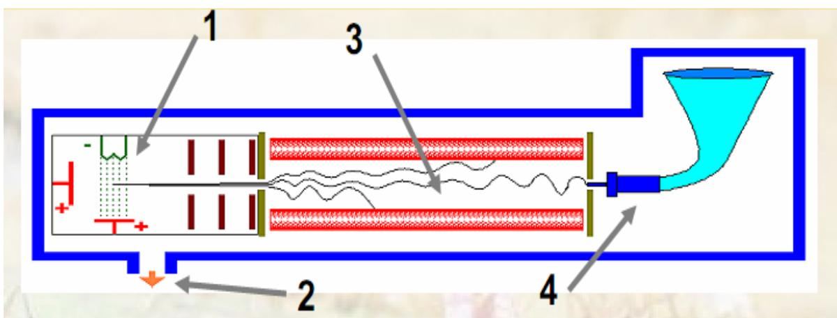
**Esquema 1:** Esquema de um Espectrômetro de massa (EM): 1: Câmara de Ionização; 2: Saída de Vácuo; 3: Separador Magnético; 4: Detector
