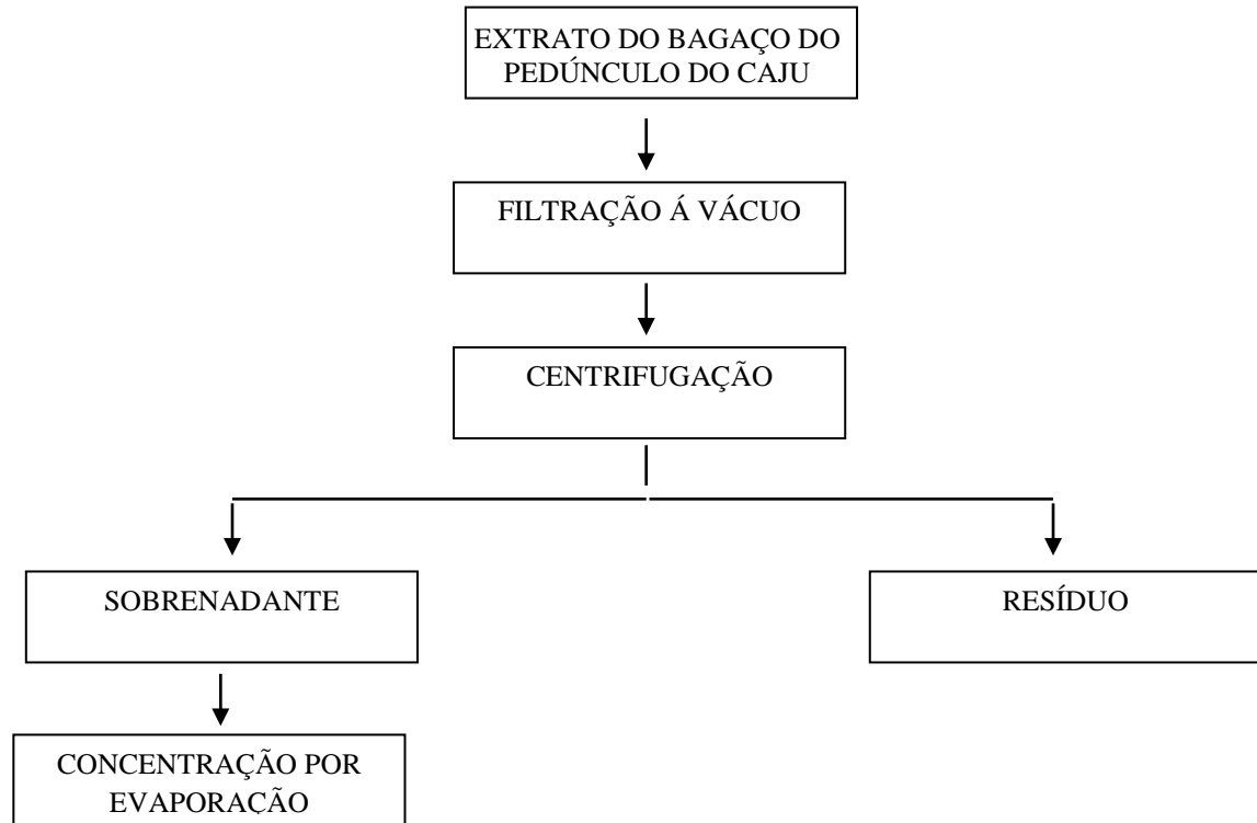
Figura 11 - Esquema de concentração por evaporação do extrato do bagaço do pedúnculo do caju.
