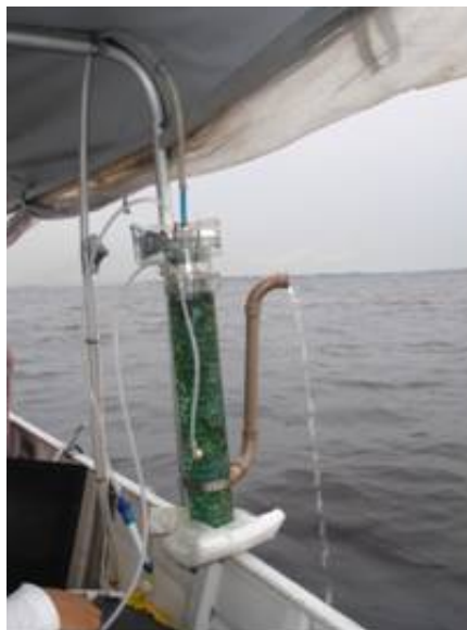
Figura 1.6 - Foto do equilibrador, modificado a partir de Frankignoulle et al. (2001), para determinação da pressão parcial de \text{CO}_2 na água
