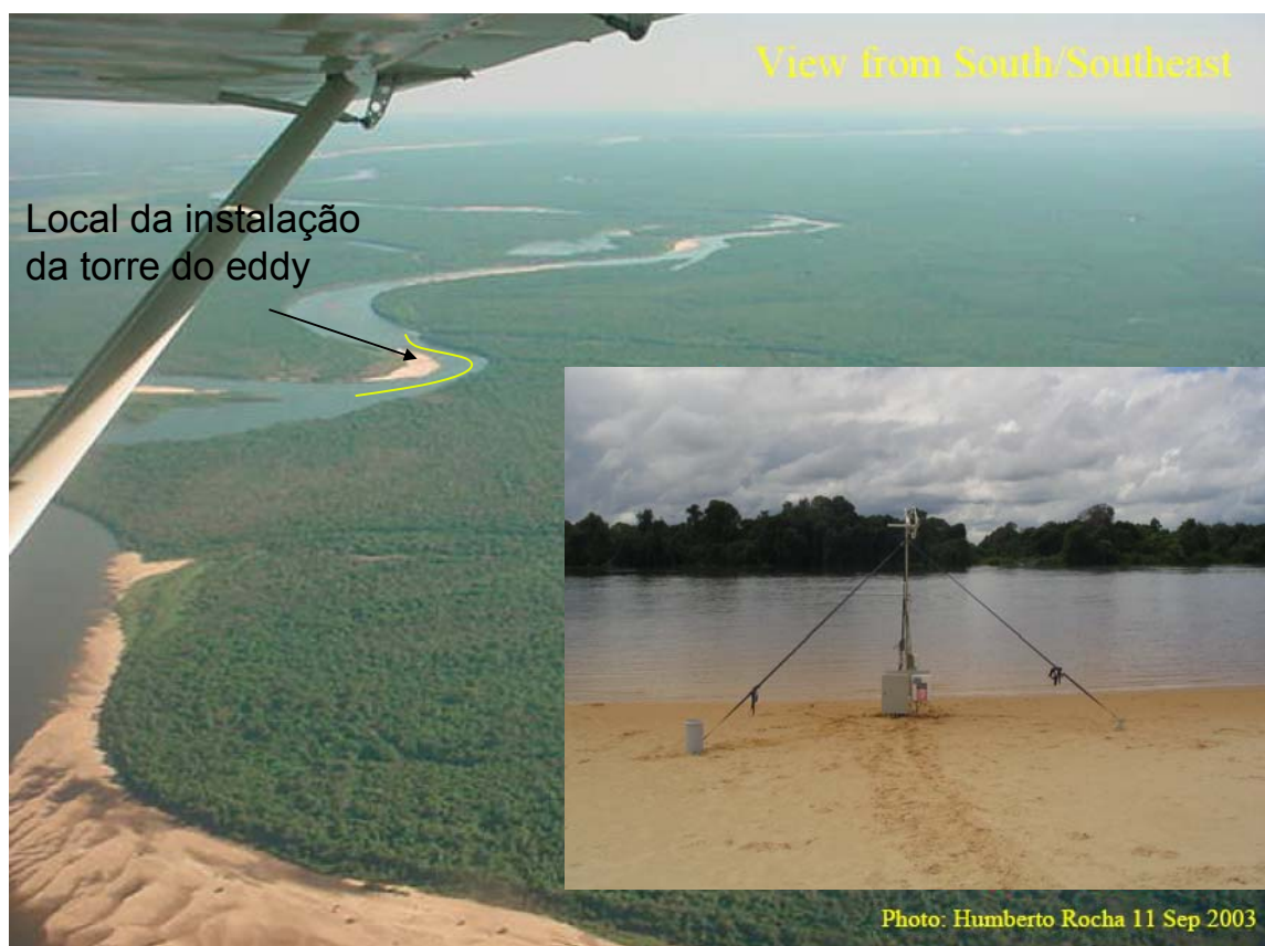
Figura 1.5 - Local onde foi montada a torre de eddy (foto em destaque) na margem do rio Javaés. A linha clara sobre o rio corresponde ao trecho de amostragem com a câmara. Foto gentilmente cedida por Humberto Rocha
