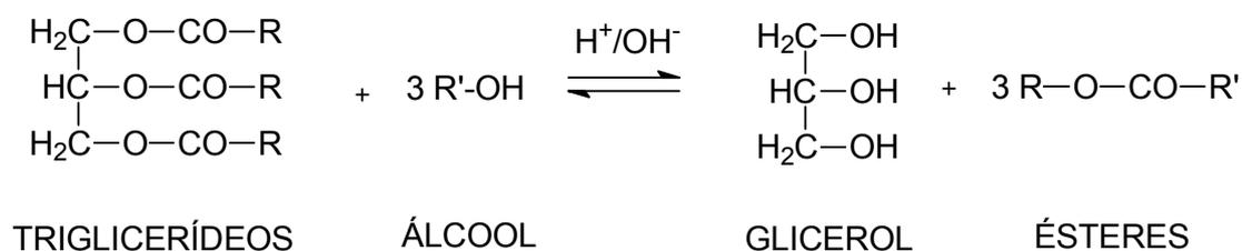
Figura 1.1. Reação de transesterificação de triglicerídeo com álcool (metanol ou etanol), *R*: grupo alquila; *R'*: CH<sub>3</sub>- ou CH<sub>3</sub>CH<sub>2</sub>- (Fonte: Kucek, 2004).
