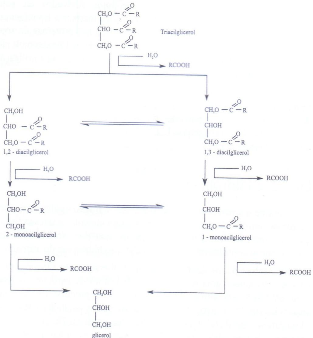
Figura 1.5. Hidrólise do triglicerídeo (Fonte: Araújo, 2004).
