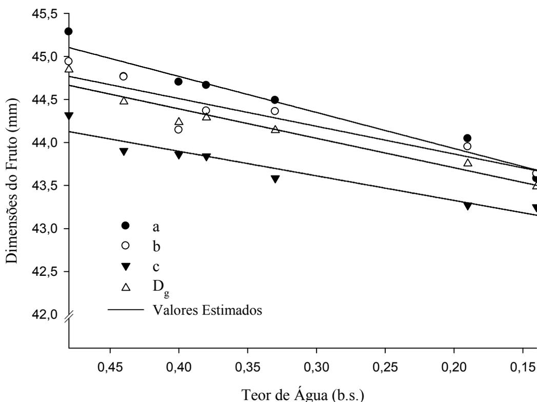
Figura 2.2. Dimensões características dos frutos de macaúba em função do teor de água (*a*: maior dimensão característica, *b*: dimensão característica média, *c*: menor dimensão característica,  $D_g$ : diâmetro geométrico médio do fruto de macaúba).
