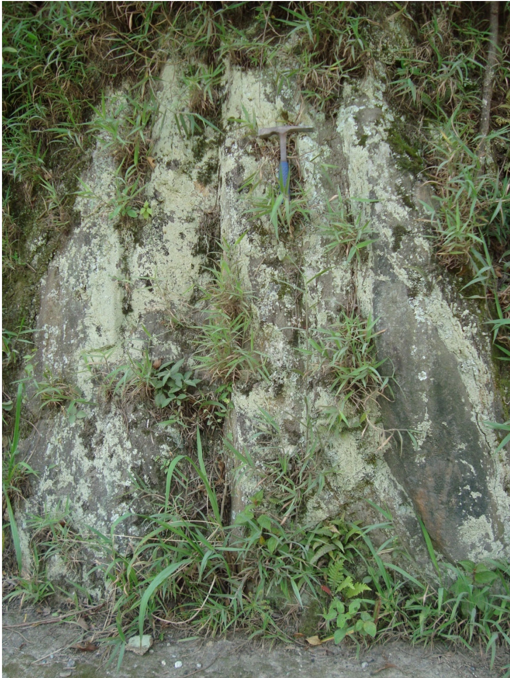
Figura 23 - Fraturas abertas, em rocha migmatítica, formando série com espaçamento de 20 cm. Ponto 09, rumo da foto: azimute 40.
