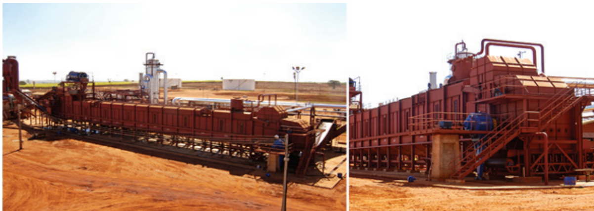
Figura 2.14: Difusor da Usina Dracena com capacidade de 6.000 t de cana por dia. (Fonte: UNI-SYSTEMS).
