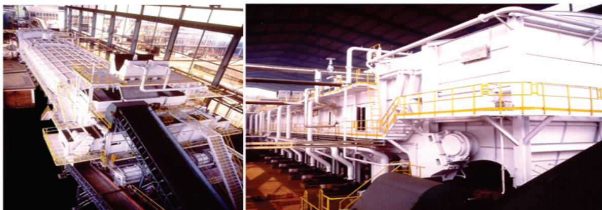
Figura 2.10: Difusor da Usina Vale do Rosário com capacidade de 12.000 t de cana por dia. (Fonte: UNI-SYSTEMS).
