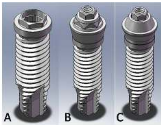
Figuras: 10A) Modelo 3D do implante, 10B) pilar de duas peças e 10C) pilar corpo único
